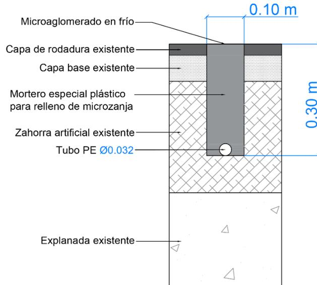
Figura 3. Esquema de microzanja en pavimento.
